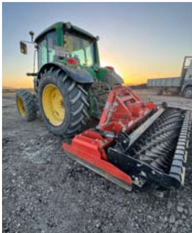
Figura 69. Tractor amb grada rotativa. Font pròpia.
