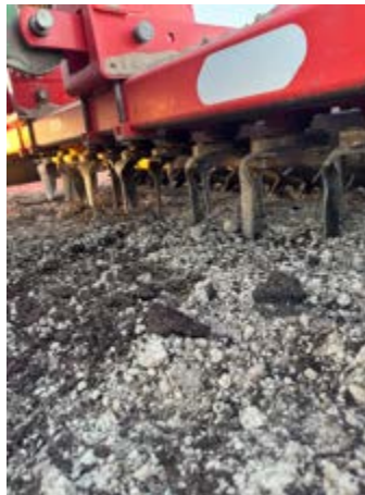
Figura 70. Paletes de la grada rotativa. Font pròpia.
