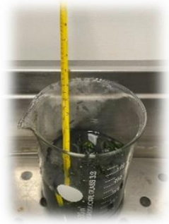
Il·lustració 16: vas de precipitats amb les algues, l'oli i el termòmetre.
