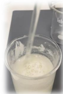
Il·lustració 19: agitador mesclant les dues fases de la crema.
