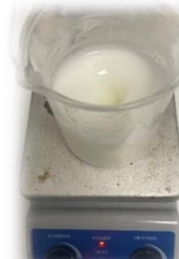
Il·lustració 20: agitador magnètic emulsionant les dues fases.
