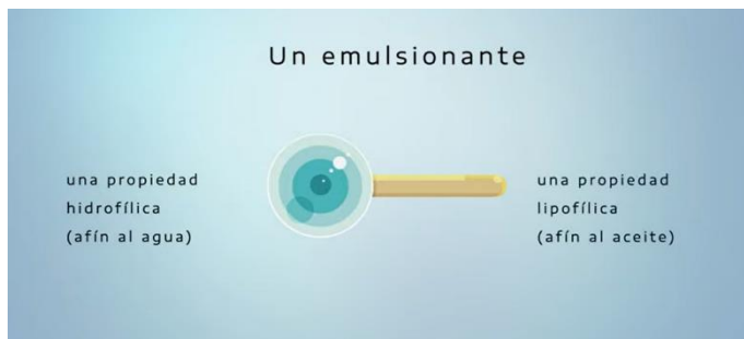
Il·lustració 1: dibuix de les parts d'un emulsionant.
