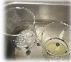
Il·lustració 18: els dos vasos de precipitats al termòstat.
